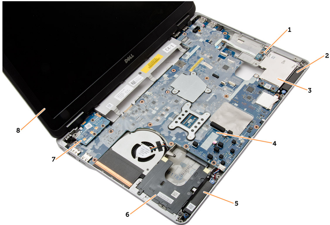
Figur 2. Vy ovanifrån – Tangentbord och handledsstödet borttagna
